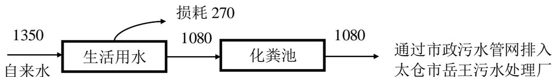
图 1-2 原有项目用排水平衡图
