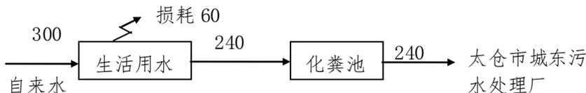
图 5-2 建设项目用排水平衡图 (单位 t/a)
