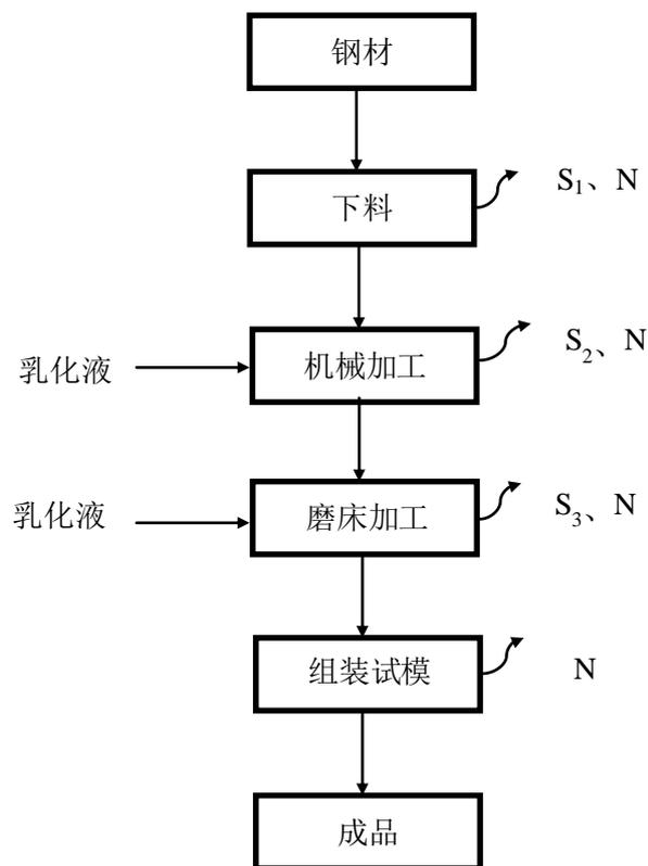
图 5-1 项目生产工艺及产污环节图
