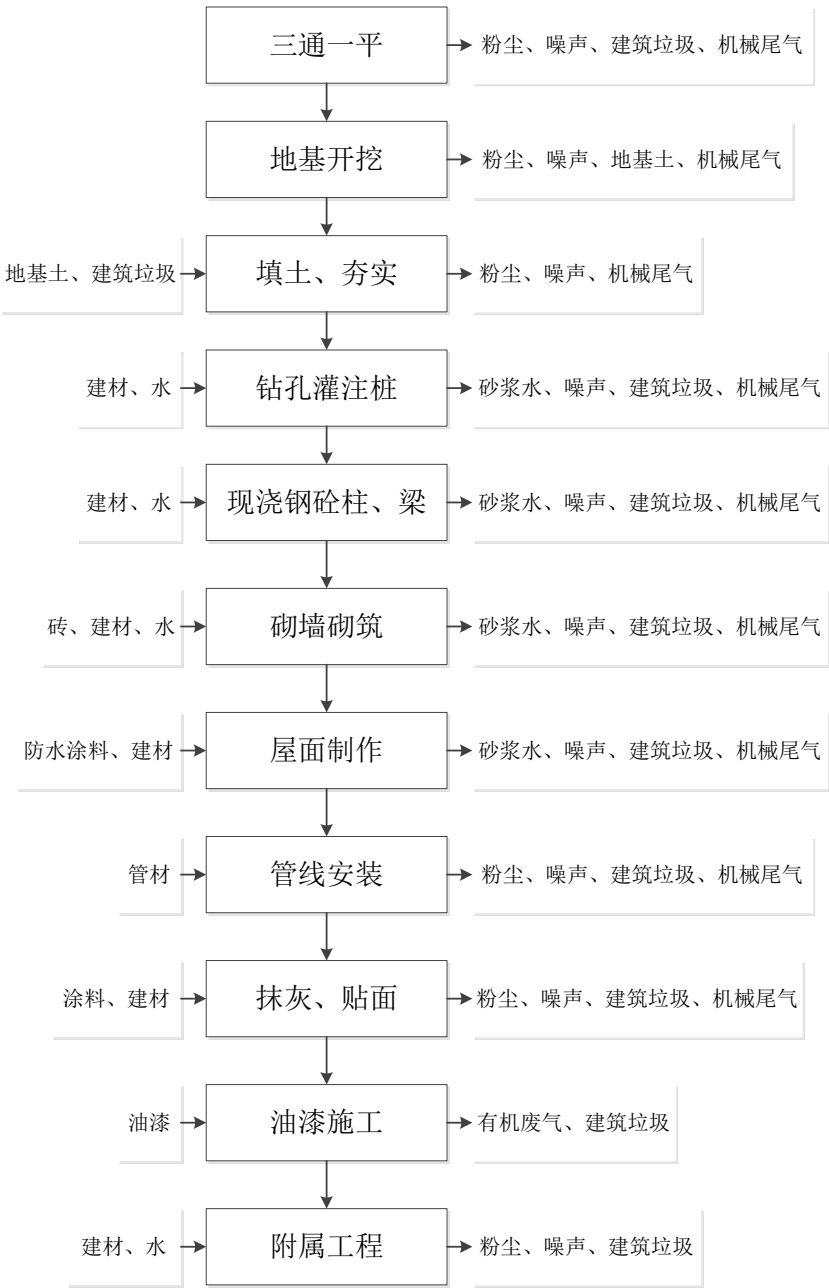
图 5-1 施工期基本流程及产污环节图
