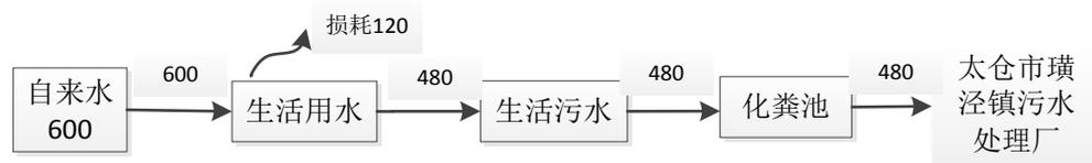
图5-2 水平衡图 （单位：t/a）
