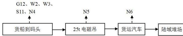
图 3.3-2 材料码头接收原材料流程
