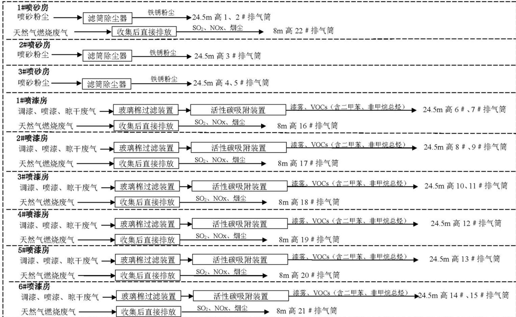
图 8.2-1 拟建项目废气污染治理系统设置示意图
