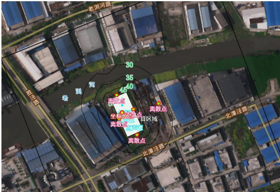
图 7-2 本项目噪声预测声等值线图
