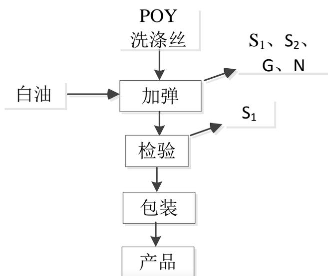
图 5-1 本项目生产工艺及产污环节图
