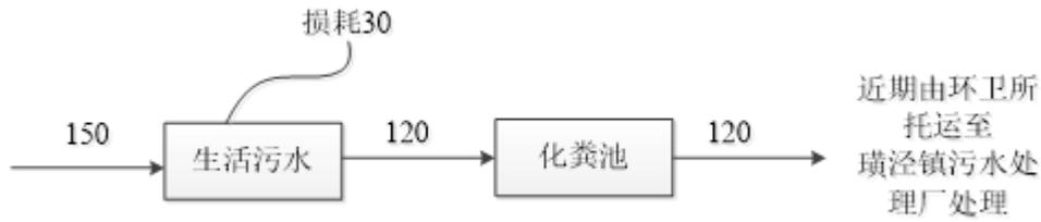
图 5-3 项目水平衡图 单位： t/a
