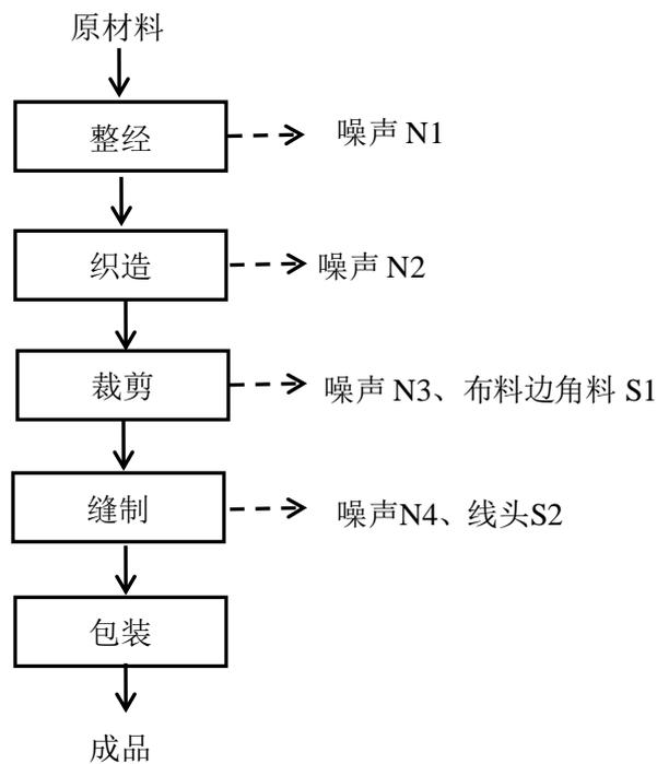
图 5-1 清洁用品生产工艺流程图
