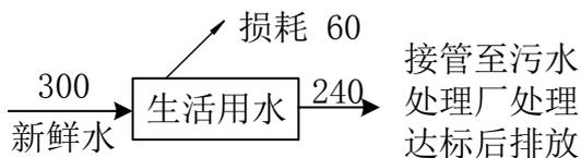
图 1-2 原有项目水平衡图 单位：t/a
