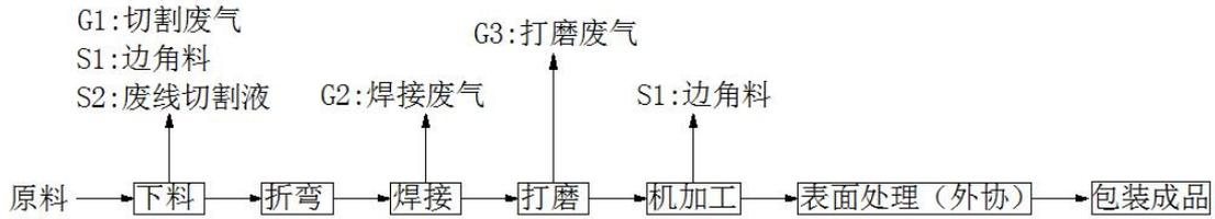
图 5-1 工艺流程及产污环节图
