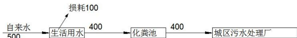
图5-2 项目水平衡图
