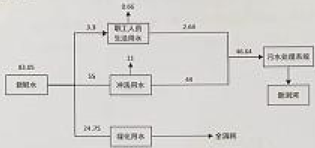
图 4-1 项目厂区内水平衡图 (m³/a)
