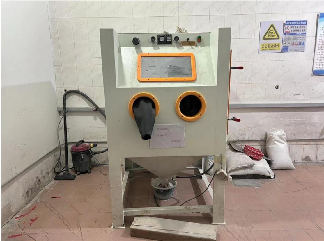
图 4-4 喷砂机自带除尘装置
