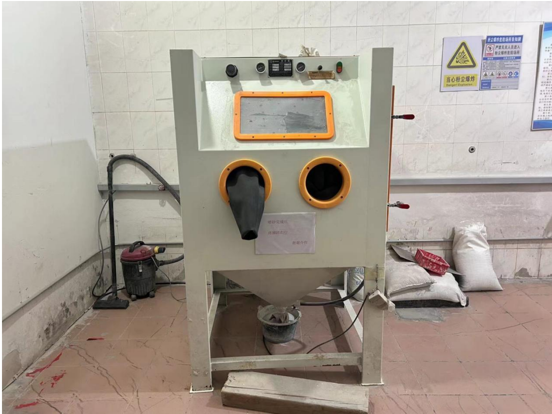
图 4-4 喷砂机自带除尘装置
